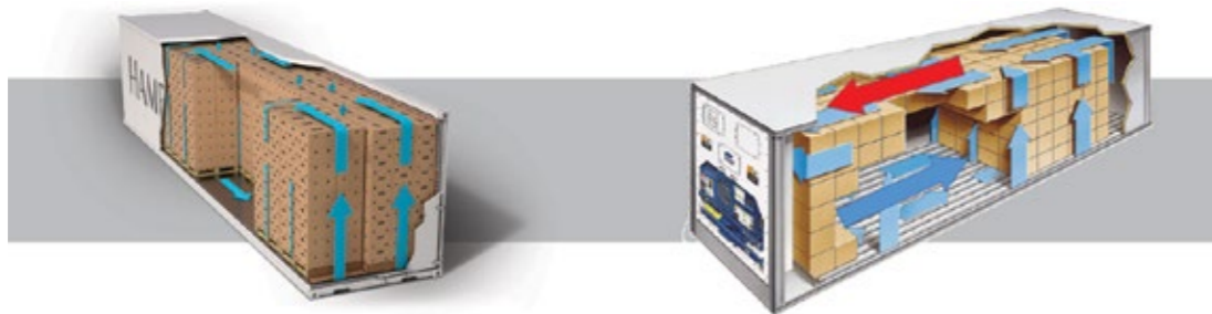
Figura 6: Sistemul de distribuție a aerului prin partea de jos
