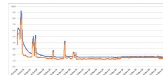
Figura 24: Datele privind monitorizarea temperaturii în timpul transportării merelor (anterioară și posterioară a containerului)
